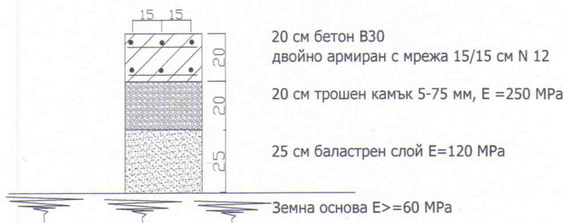
Фиг. 1 – детайл стоманобетонена настилка
