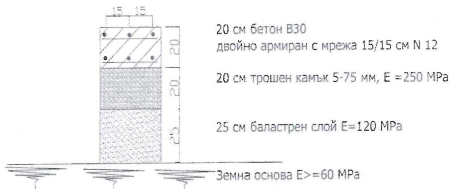
Фиг. 1 - Детайл стоманобетонна настилка
