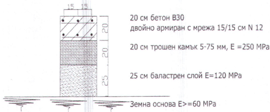
Фиг. 1 - Детайл стоманобетонна настилка
