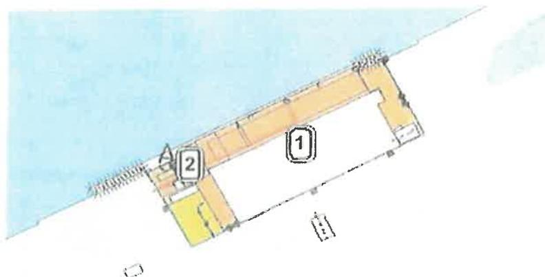
а) Корабно място № 2 на км. 432,700 с дължина 30 м, оборудвано с понтон за престой и снабдяване на пътнически и самоходни кораби; обслужване на пътници. Размерите на понтон са 22 x 8 x 3 м.
